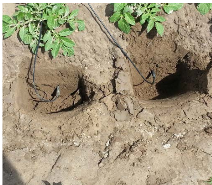
Rys. 2.7. Czujniki zainstalowane w plantacji ziemniaka (zdj. R. Wawer)
