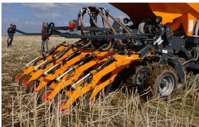
Rys. 2.6. Jednoczesny siew z dogłębnym stosowaniem nawozów jest jednym z podstawowych elementów rolnictwa konserwującego w zakresie nawożenia (zdj. Jerzy Kozyra, Projekt LCAgri)
