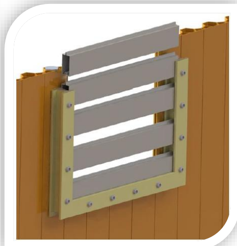
Prowadnice U-kształtne z dwuteowników o szerokości wewnętrznej 8
